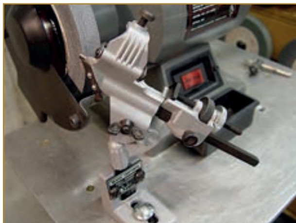
شکل ۱۹-۹- تیز کردن مته به کمک ابزار مخصوص
