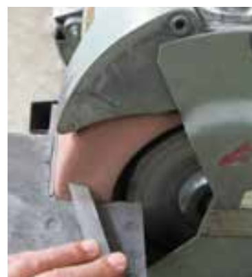
شکل ۴-۹ تیز کردن زاویه آزاد پیشانی
