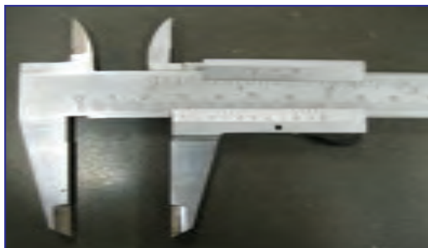
شکل ۱-۴۷- خواندن کولیس ورنیه
