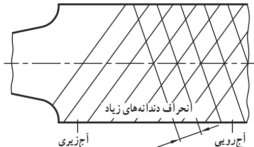
شکل ۹-۴- وضعیت آج ها با زوایا و گام های مختلف
