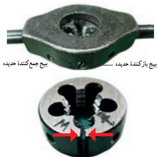
شکل ۶-۱۱ - دسته حدیده برای حدیده‌های درزدار
