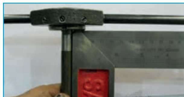
شکل ۶-۱۳ - کنترل عمود بودن محور میله با دسته حدیده
