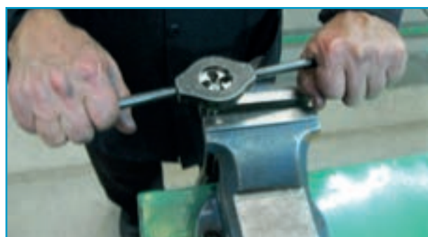
شکل ۶-۱۲ - نحوه اعمال نیرو در حدیده‌کاری
