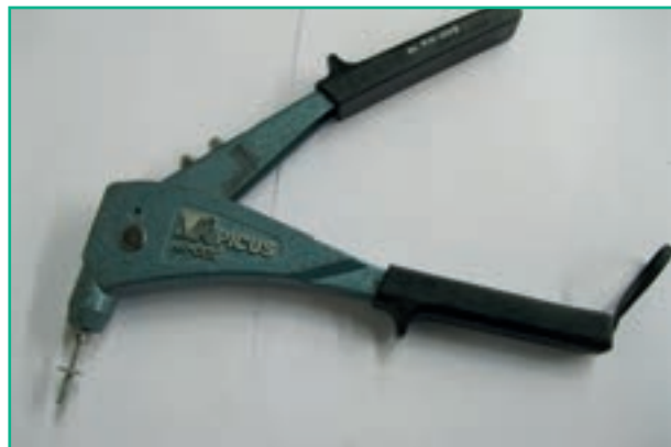
شکل ۷-۱۲- جا زدن پرچ روی انبر پرچ
