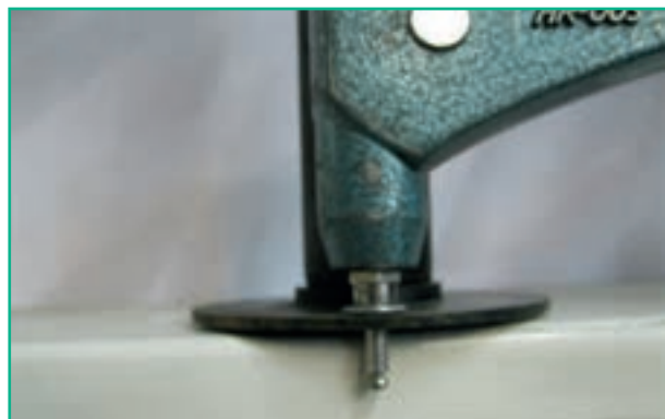
شکل ۷-۱۳- جا زدن پرچ داخل سوراخ
