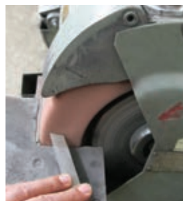
شکل ۴-۹ تیز کردن زاویه آزاد پیشانی
