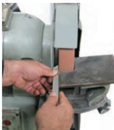
شکل ۴-۱۱ تیز کردن زاویه براده
