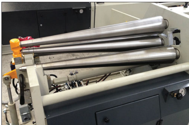
شکل ۵: غلتک‌های مخروطی می‌تواند بر روی دستگاه نورد برای تولید مخروط مورد استفاده قرار گیرد به جای اینکه به دنبال تنظیم و زاویه‌دار کردن غلتک‌های استوانه‌ای و موازی دستگاه باشیم.
