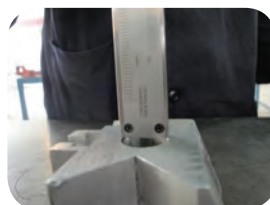
کنترل عمق سوراخ با استفاده از کولیس
