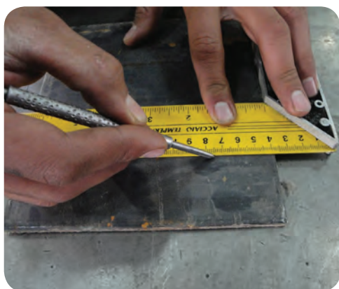
روش ترسیم خط به کمک گونیاى ساده و سوزن خطکش
