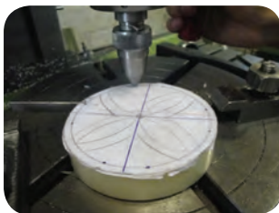
انطباق نوک مخروطی میله با مرکز قوس قطعه
