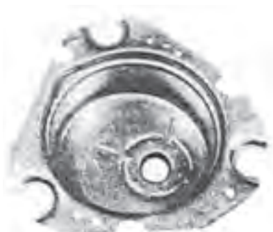
شکل ۲-۳۸ ایجاد برجستگی برای جوشکاری
