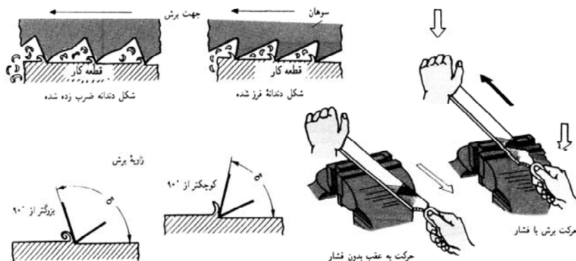
شکل ۱-۲۸ روش سوهان کاری
