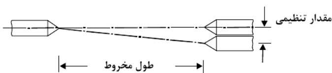
شکل ۳۴-۴ روش مخروط تراشی با انحراف مرگک
