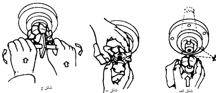
شکل ۱۸-۵ روش بستن تیغه فرزاها
